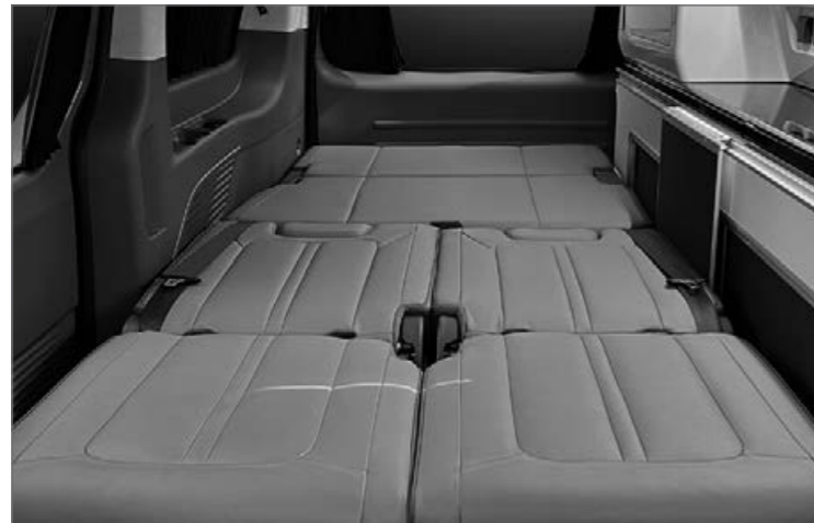
3. 2열 시트가 완전히 눕혀지면 3열 벤치와 떨어진 빈 공간을 시트 이동 레버를 이용해 메워줍니다.
