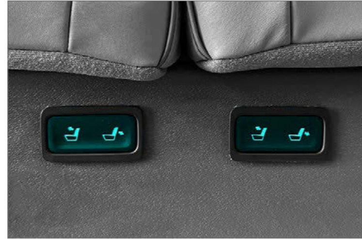
2. 시트 하단 리클라이닝 버튼을 각각 한 번씩 눌러 시트 등받이를 뒤로 젖힙니다. (좌우 시트는 개별 조작이 가능하며, 동작 중 한 번 더 버튼을 누를 시 시트 작동이 멈춥니다.)
